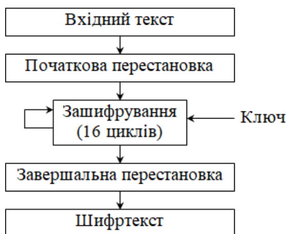
Рисунок 1.5 – Узагальнена схема шифрування в алгоритмі DES
